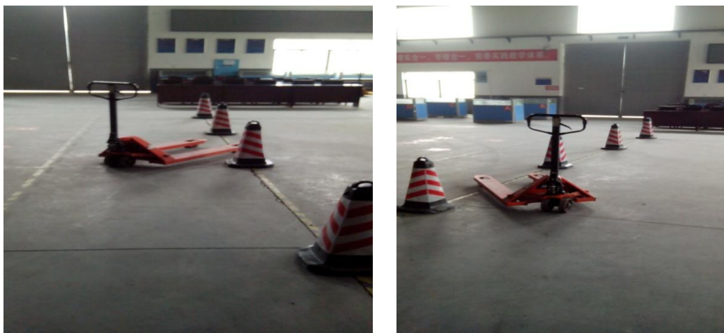
图 1-02 地牛的“S”型行驶路线图
