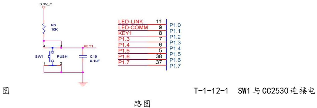
SW1 按键的一侧 (3、4 号引脚) 通过一个上拉电阻连接到电源，同时连接到 CC2530 的 P1\_2 引脚，另一侧 (1、2 号引脚) 连接到地。当按键没有按下时，由于上拉电阻的存在，CC2530 的 P1\_2 引脚相当外接了一个上拉电阻，呈现高电平状态。当按键按下时，按键的 4 个脚导通，CC2530 的 P1\_2 引脚相当于直接连接到地，呈现低电平状态。电容 C19 起到滤波作用，具有一定的消抖功能。
